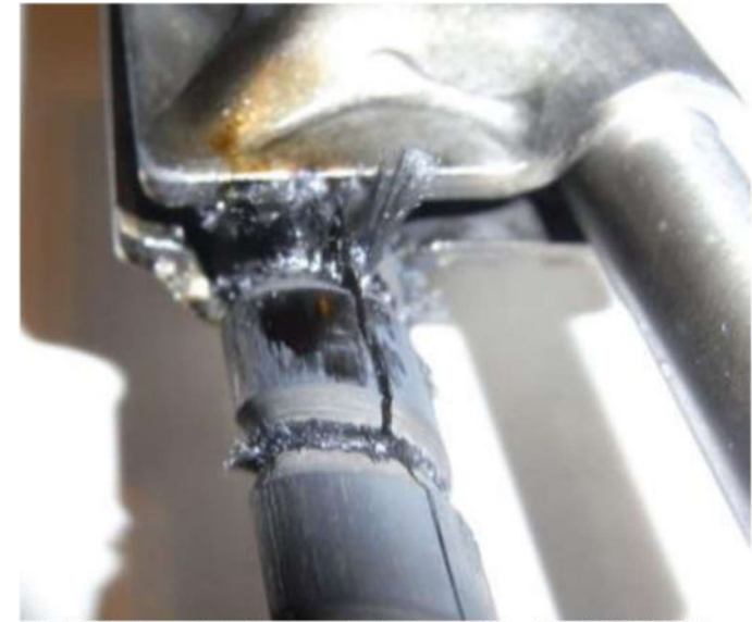
CFK-Stab nach Blitzstrombelastung (Quelle: DEHN SE)
